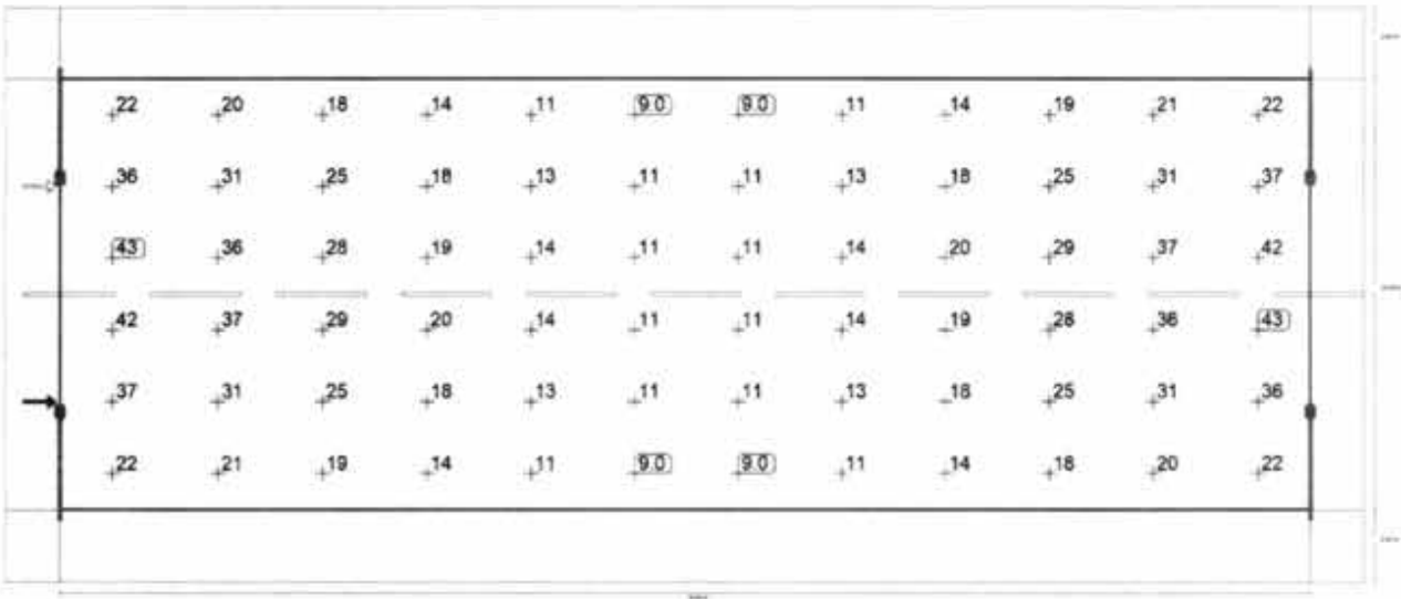
Valor de manutenção de iluminância horizontal [lx] (Grelha de valores)
